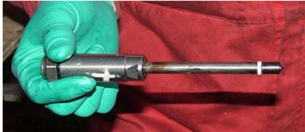
Usura e corrosione degli iniettori
