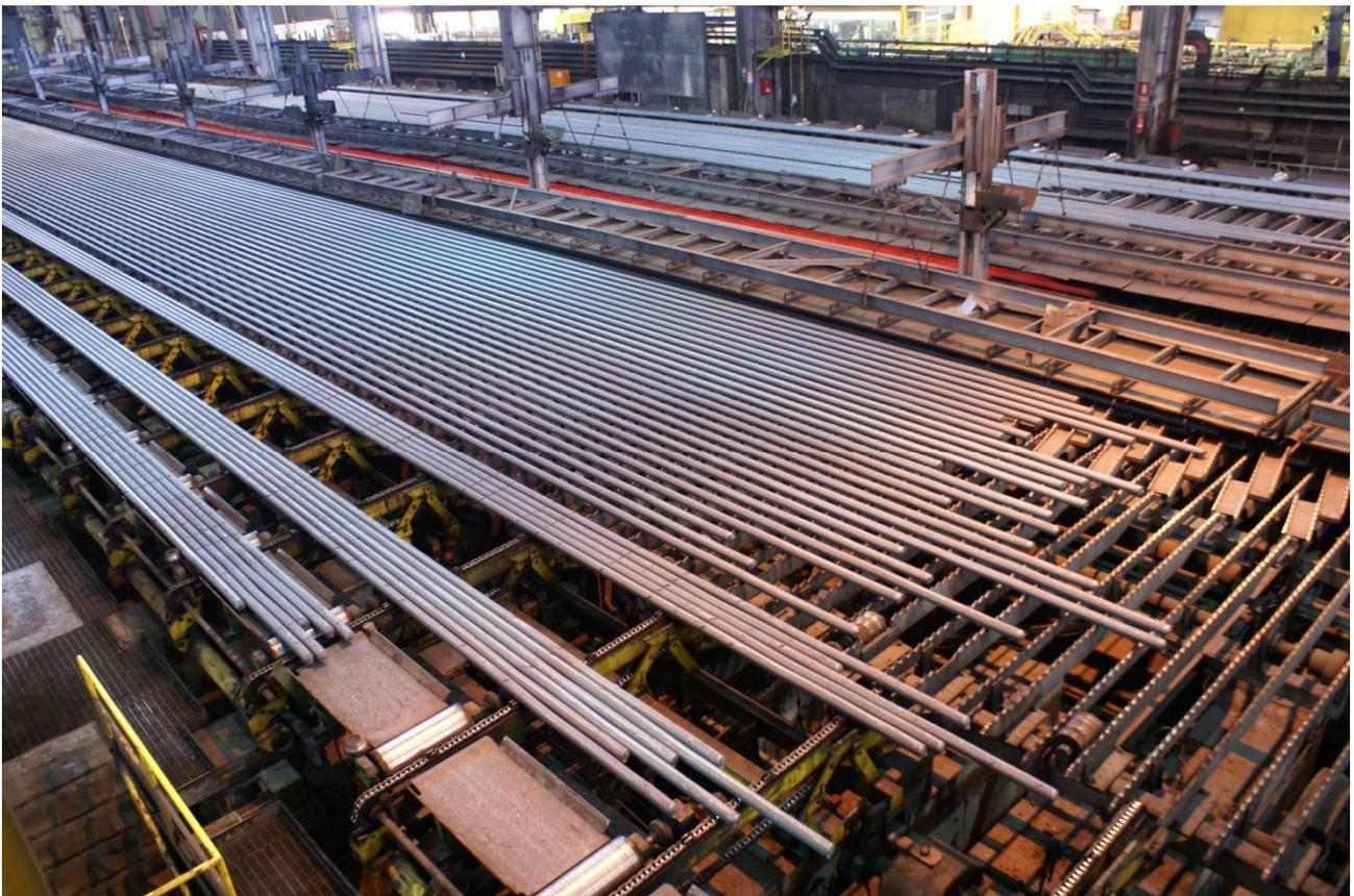
*Fig. 34 – Placche di raffreddamento durante la marcia del treno di laminazione*
