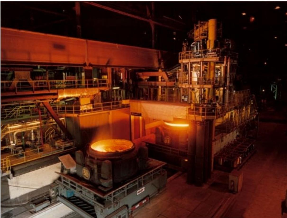
*Fig. 21- Esempio di un impianto di metallurgia in siviera*
