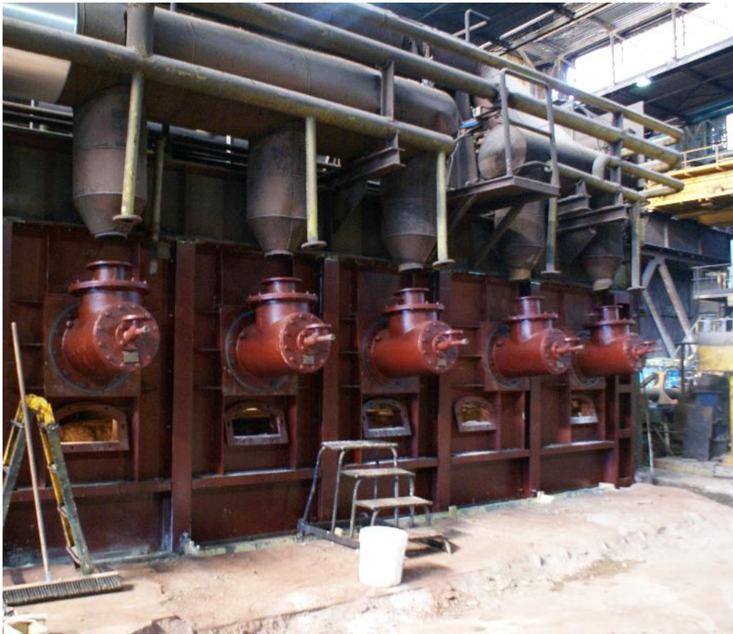
*Fig. 26 – Bruciatori del forno di riscaldamento billette del TMP*
