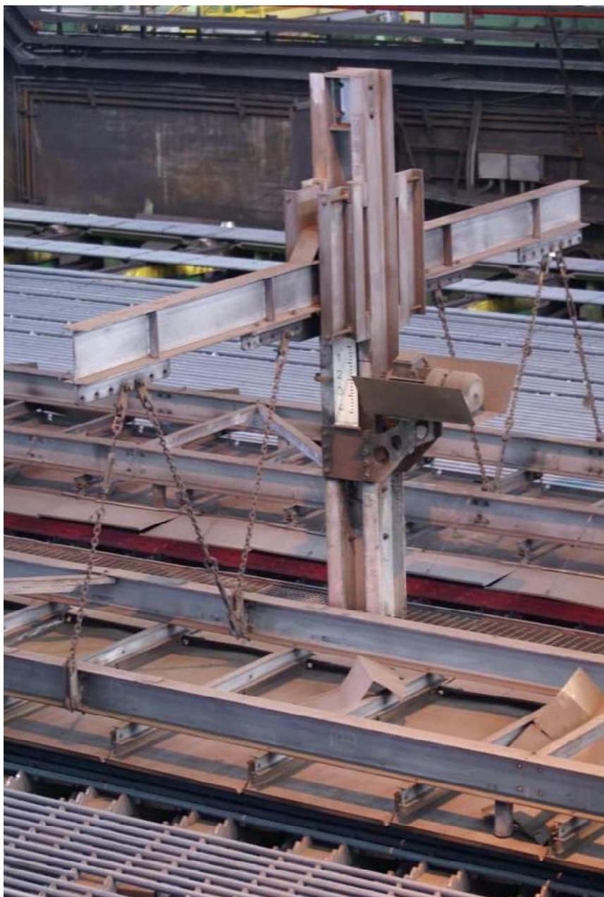
*Fig. 60 – Sistema di movimentazione cappe con scala graduata per controllo altezza*
