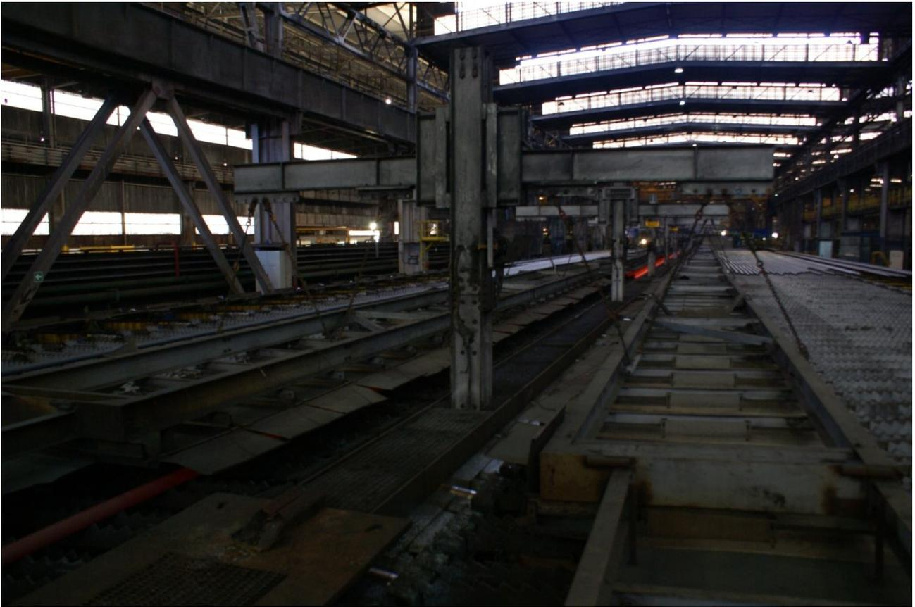
*Fig. 33 – Sistema di arresto barre e posizionamento sui rastrelli*
