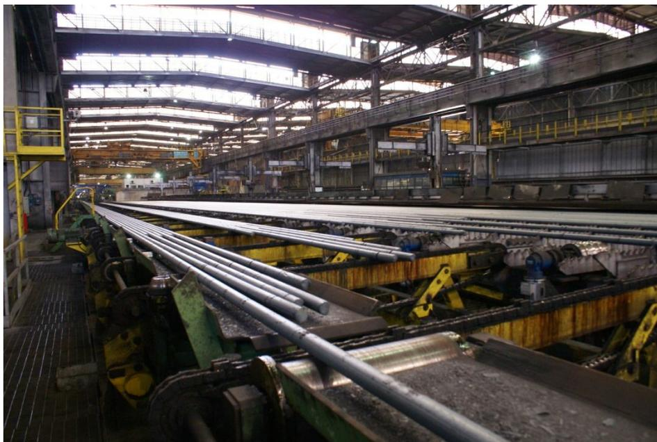
*Fig. 57 – Zona di formazione del fascio per invio a taglio e confezionamento*
