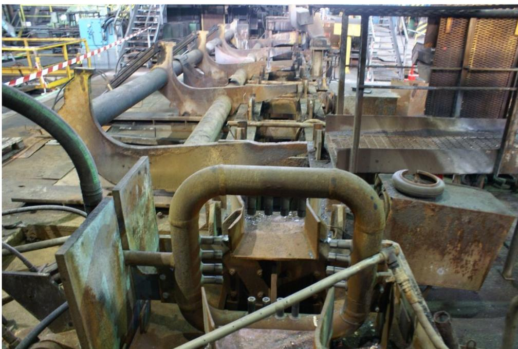
Fig. 28 – “Toro” di discagliatura ed evacuatore
