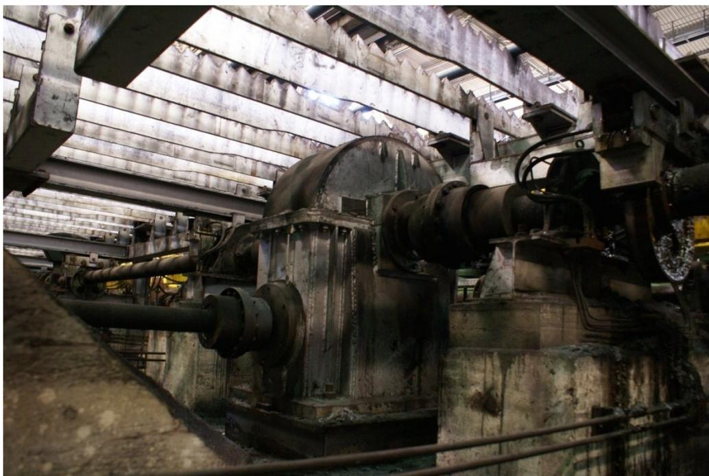
*Fig. 66 – Riduttore con assi a  $90^\circ$ : ingresso del moto a sinistra, uscita in direzione ortogonale*
