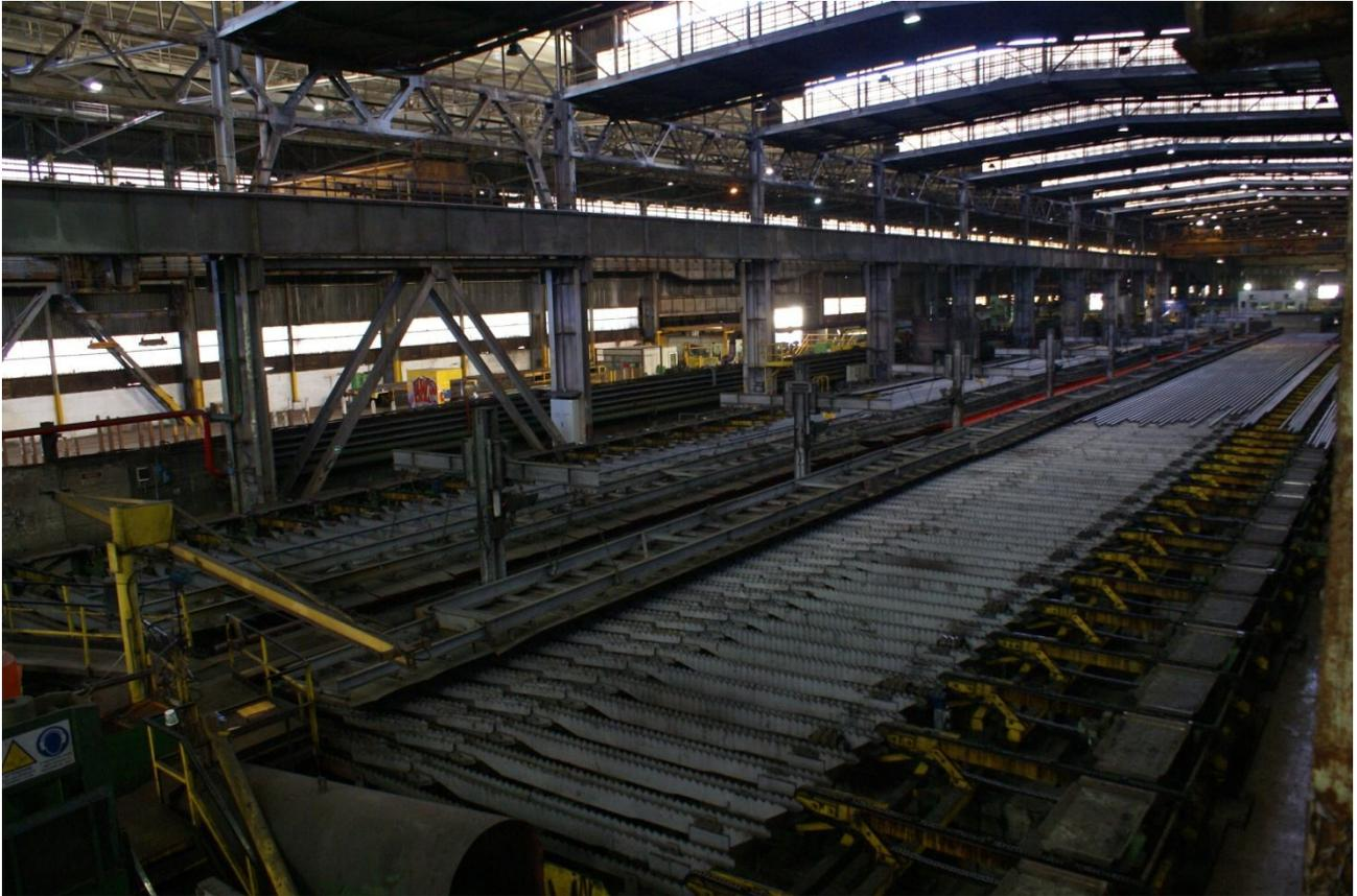
*Fig. 62 – Placche del sistema di raffreddamento barre TMP*
