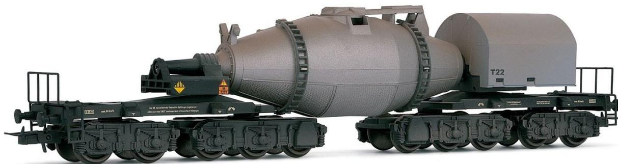
*Fig. 19 – Struttura tipica di un carro siluro (con una massa a vuoto di circa 200 tonnellate e circa 600 a pieno carico si comprende la necessità di un elevato numero di assi)*
