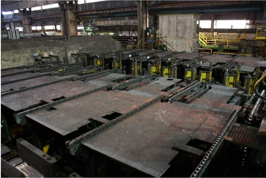
*Fig. 37 – Sistema di avanzamento barre da ascensore a discensore*
