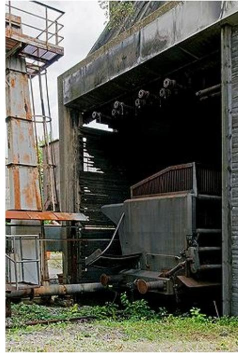
*Fig. 16 – Punto di stazionamento del carro di spegnimento per il raffreddamento del coke, sotto la torre di quenching della cokeria Hansa (Dortmund, Germania, 2010)*
