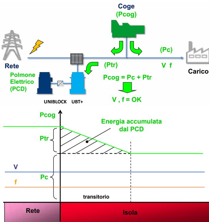
Questo sistema può essere inserito in impianti di cogenerazione in bassa o media tensione, che impiegano motori a gas di qualsiasi marca, durante la fase di progettazione o successivamente. Piller è, inoltre, leader nel campo della continuità elettrica, producendo UPS rotanti da 625 a 3.600 kVA, con volano e/o con diesel.
