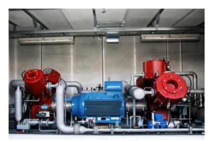
Compressore DA300 TANDEM per BioGNL
