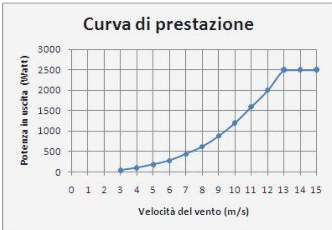
Fig. 4.1 - Curva di prestazione aerogeneratore in ordinata la potenza generata e in ascissa la velocità del vento.
