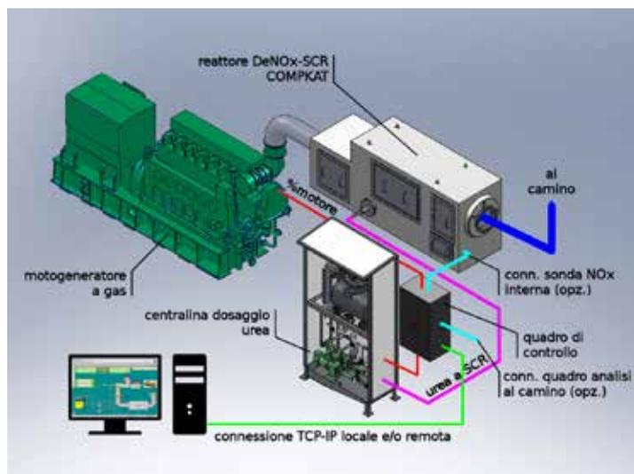
Schema tipico di impianto DeNOx-SCR per l'abbattimento combinato di NOx, CO, COT, NH<sub>3</sub> presenti nelle emissioni da motogeneratori alimentati a biogas, gas naturale o di sintesi
