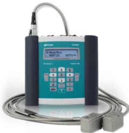
esternamente al tubo, oppure immerse. Il convertitore elettronico che fa la misura della portata e riceve l'informazione della temperatura è anche il contatore di energia termica.
