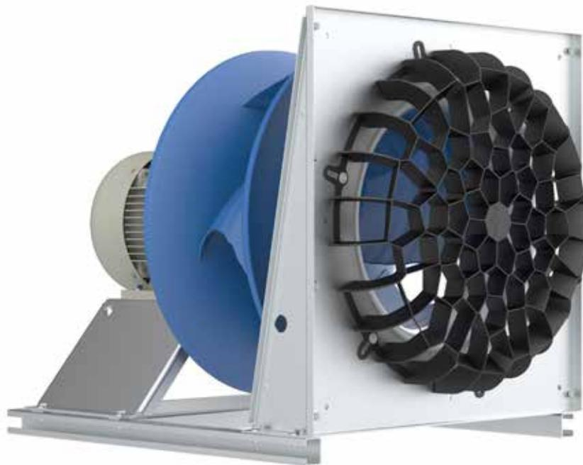
La serie di ventilatori plug fan ZAbbluefin, appositamente sviluppati per le UTA, si completa con una speciale griglia che consente di ridurre ulteriormente la rumorosità degli impianti di climatizzazione.
