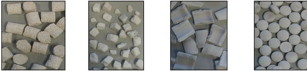
**Figure 3.3** – Porous carrier, (a) Biomax®; (b) glaxstone; (c) Siporax® cylinders; (d) Siporax® mini.
